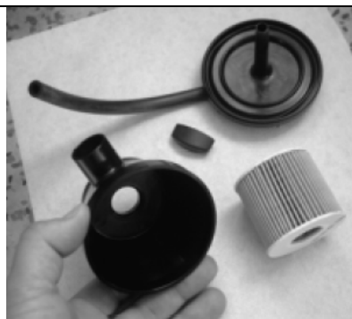
рис.4: Очистите корпус, производя осмотр на наличие повреждений (трещины и т.п.)
