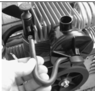
рис.1: Снимите шланг сапуна картера.
