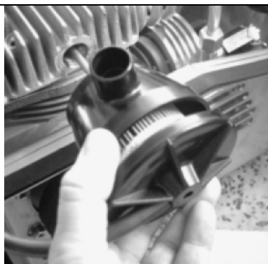
рис.2: Отвинтите барашек и снимите корпус.
