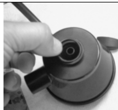
рис.6: Установите картридж на крышку и накройте сверху корпусом. Кольцевое уплотнение установите в соответствующую канавку.
