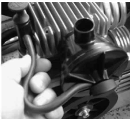
рис.8: Затяните монтажный барашек и заново закрепите шланг сапуна картера к корпусу фильтра и маслозаливной горловине.
