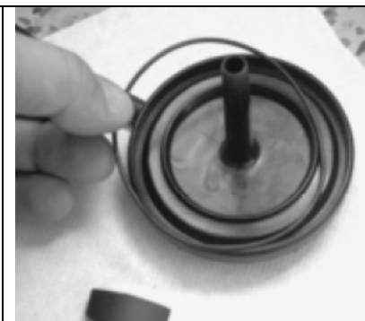
рис.5: Установите уплотнение O-ринг в крышку корпуса.
